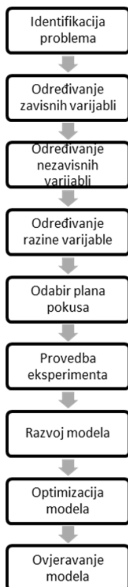
Slika 7 Shematski prikaz glavnih koraka za provedbu RSM (Aydar, 2019).
