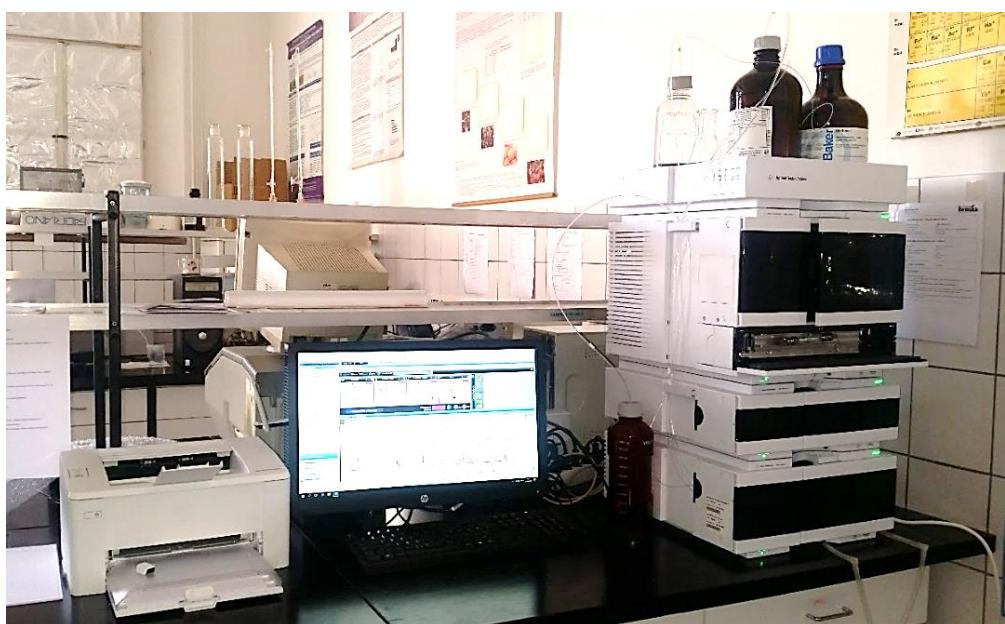
**Slika 25** Visoko djelotvorni/tlačni tekućinski kromatograf sa detektorom s nizom dioda
