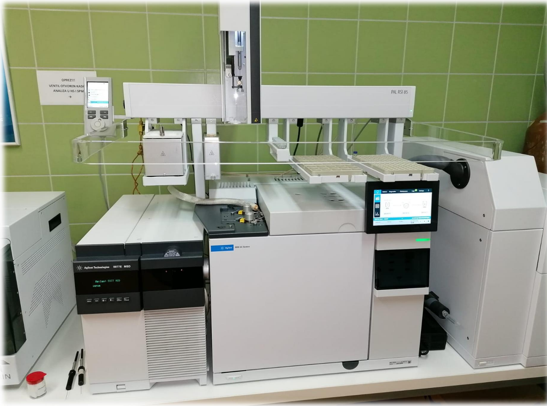
Vezani sustav plinska kromatografija-spektrometrija masa (GC-MS); Agilent Technologies GC 7890 A i MSD 5977
