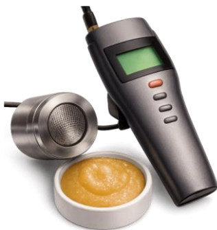
Slika 28 Grafički prikaz uređaja za mjerenje aktiviteta vode u kaši jabuke (Izvor: autor)
