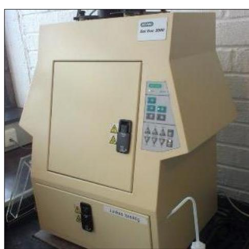
**Slika 6.** UV transiluminator – Uređaj za vizualizaciju i očitavanje rezultata s elektroforeze
